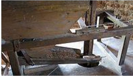
La trémie pour le passage du grain
